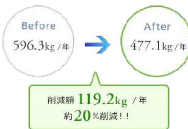
1馬力のエアコンを1年間使用した場合のCO<sub>2</sub>排出量はおよそ596.3kgです。通常、ハイブリッドファンを使用することにより、エアコン設定温度を2℃外気温に近づけることができますので、これらを元にCO<sub>2</sub>排出量を計算した結果、**CO<sub>2</sub>排出量は約20%減**の477.1kgになります。
